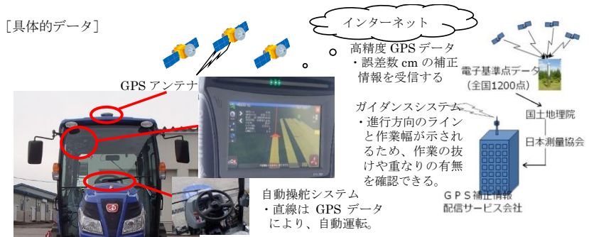
図 1 GPS 自動操舵トラクタの構成
