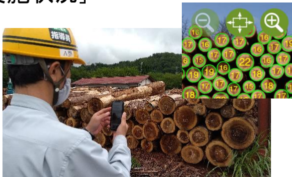
丸太検知アプリを活用した伐採木の計測作業の効率化を実証
