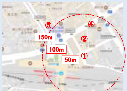
同心円の中心位置(①)の消雪設備の稼働により、周辺井戸(②~⑤)の地下水位が距離に応じて1時間後に0.3~0.5m程度低下
